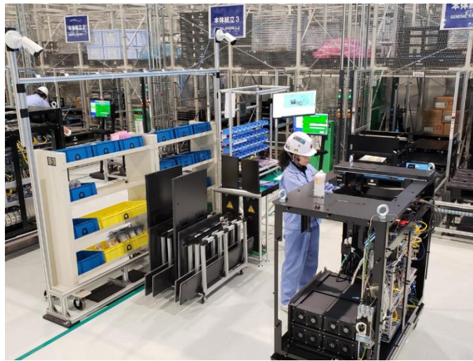
アマダ富士宮事業所に構築した「組立ナビゲーションシステム」
